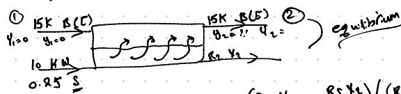
$$\% \text{ extraction of water} = (R_S X_1 - R_S Y_1) / (R_S X_1) * 100\%$$
