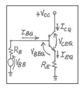
$$KVL: -I_{EQ}R_E - V_{CEQ} + V_{CC} = 0$$
