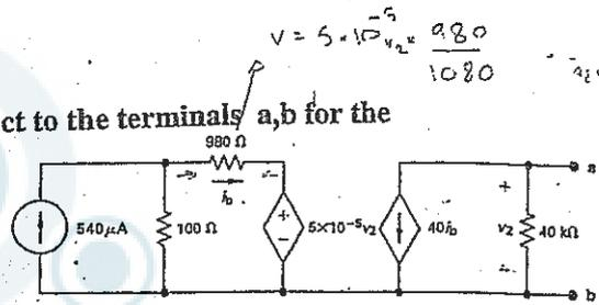
$$i_b = 540 \times 10^{-6} \times \frac{100}{1080} - 5 \times 10^{-5} v_2$$
